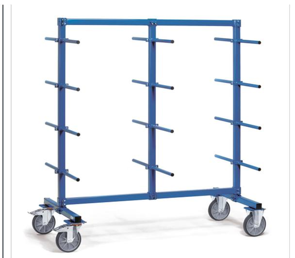
Ensemble mécano-soudé, revêtement époxy bleu RAL 5007. Système modulable pour éléments longs et stockage. Chariot complètement boulonné, barres réglables en hauteur. 2 faces avec 24 barres de portée (12 de chaque côté). Longueur utile : 370 mm. 2 roues fixes et 2 roues pivotantes à bandage TPE, moyeu à roulement à billes. Freins sur roues pivotantes conformément à la Norme EN 1757-3. Charge par étage : 120 kg (60 kg de chaque côté).
