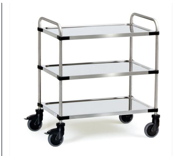
Chariot Inox avec tube en chrome-nickel-acier. 3 plateaux emboutis en chrome et acier avec isolant phonique. Armature avec pastilles de protection en plastique. 4 roues pivotantes inoxydables à bandage TPE élastique confortable et non traçant, moyeu à roulement à billes. 2 roues avec freins. Conformément à la Norme DIN 18867 partie 8. Charge maximum par plateau : 80 kg. Livré démonté, montage facile.
