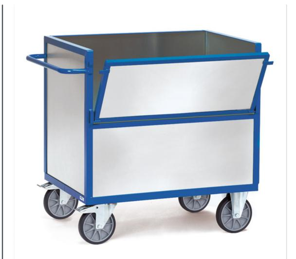
Ensemble mécano-soudé revêtement époxy RAL 5007. Chariot entièrement en tôle d'acier zinguée collée dans les profilés. 2 roues pivotantes et 2 roues fixes à bandage TPE, moyeu à roulement à billes central. Freins sur roues pivotantes conformément à la Norme Européenne EN 1757-3 (Sécurité des chariots de manutention).
