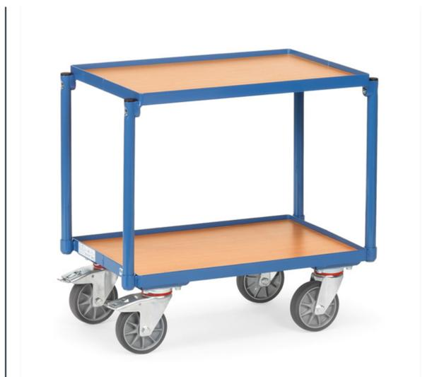
Construction en profilé d'acier, revêtement époxy bleu RAL 5007. 2 plateaux en mélaminé surface effet hêtre avec rebord de 15 mm, distance entre les plateaux : 400 mm. Hauteur totale : 639 mm. 4 roues pivotantes à bandage TPE, moyeu à roulement à billes central. 2 roues avec freins conformément à la Norme EN 1757-3. Compatible pour bacs plastiques 600 x 400 mm.
