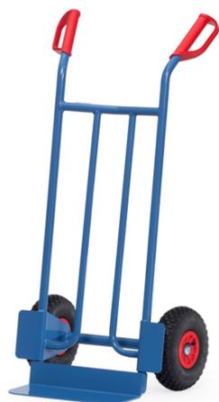
Ensemble mécano-soudé en tube et tôle d'acier, revêtement époxy bleu RAL 5007. Poignées de sécurité en plastique dur avec arceaux de sécurité. Bavette en tôle d'acier à boulonner et remplaçable. Roues gonflables, moyeu à roulement à rouleaux. Livré avec bavette démontée.
