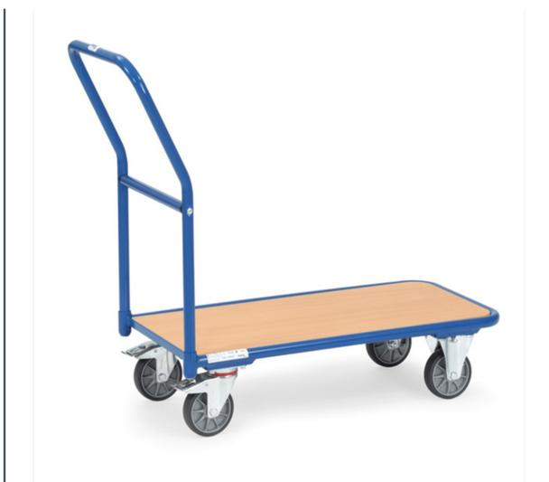
Ensemble mécano-soudé, revêtement époxy bleu RAL 5007 uniquement. Plateforme en mélaminé surface effet hêtre. 2 roues pivotantes et 2 roues fixes à bandage TPE 125 x 32, moyeu à roulement à billes central. Freins sur roues pivotantes conformément à la Norme EN 1757-3.
