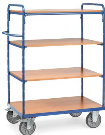
Ensemble mécano-soudé, revêtement époxy bleu RAL 5007, 1 plateau fixe et 3 amovibles en mélaminé surface effet hêtre. Plateaux amovibles réglables au pas de 100 mm. Charge maximum par plateau : 90 kg. 2 roues pivotantes et 2 roues fixes à bandage TPE, moyeu à roulement à billes central. Freins sur roues pivotantes conformément à la Norme EN 1757-3 (Sécurité des chariots de manutention).
