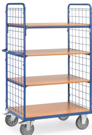
Ensemble mécano-soudé, revêtement époxy bleu RAL 5007. 1 plateau fixe et 3 amovibles en mélaminé surface effet hêtre. Ridelles avec treillis métallique 100 x 100 x 5 mm. Plateaux réglables au pas de 100 mm. Charge maximum par plateau : 90 kg. 2 roues fixes et 2 roues pivotantes à bandage TPE moyeu à roulement à billes central. Freins sur roues pivotantes conformément à la Norme 1757-3 (Sécurité des chariots de manutention).
