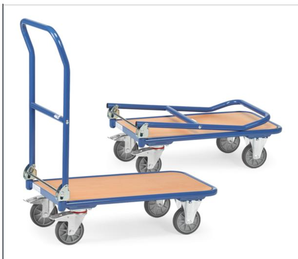
Chariot en tube d'acier, revêtement époxy avec plateforme en mélaminé surface effet hêtre. Dossier de poussée rabattable sur la plateforme. 2 roues pivotantes et 2 roues fixes à bandage TPE, moyeu à roulement à billes central. Freins sur roues pivotantes.
