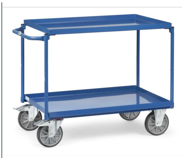
Construction en acier avec 2 plateaux étanches et rebord de 40 mm, revêtement époxy bleu RAL 5007, dossier de poussée horizontale. Charge maximum plateau du haut : 200 kg. 2 roues pivotantes et 2 roues fixes à bandage TPE, moyeu à roulement à billes central. Freins sur roues pivotantes conformément à la Norme 1757-3 (Sécurité des chariots de manutention).
