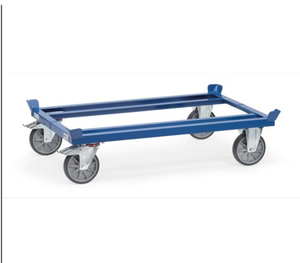
Construction en profilé d'acier mécano-soudé, revêtement époxy bleu RAL 5007, avec 4 inserts support de palettes. Pour palettes bois ou grillagées. 2 roues fixes et 2 roues pivotantes à bandage TPE, moyeu à roulement à billes. Freins sur roues pivotantes conformément à la Norme EN 1757-3. Déplacement peu bruyant sur sols plats, bandage non traçant.
