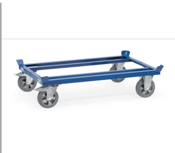
Construction en profilé d'acier mécano-soudé, revêtement époxy bleu RAL 5007, avec 4 inserts support de palettes. Pour palettes bois ou grillagées. 2 roues fixes et 2 roues pivotantes à bandage caoutchouc élastique confort, bleu-gris non traçant, moyeu à roulement à billes. Freins sur roues pivotantes conformément à la Norme EN 1757-3. Peu de résistance au déplacement. Roulement élastique, sans bruit.
