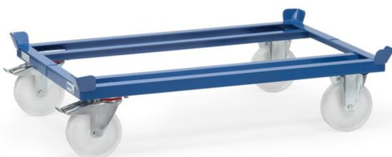
Construction en profilé d'acier mécano-soudé, revêtement époxy bleu RAL 5007, avec 4 inserts support de palettes. Pour palettes bois ou grillagées. 2 roues fixes et 2 roues pivotantes en polyamide, moyeu à roulement à rouleaux. Freins sur roues pivotantes conformément à la Norme EN 1757-3. Roulement aisé et non traçant mais bruyant. Roues résistantes aux agents corrosifs.
