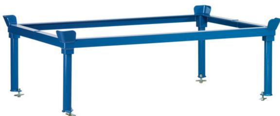
Construction mécano-soudée en profilé d'acier avec 4 supports, revêtement époxy RAL 5007. Barres de soutien avec pattes de renfort. Les supports amovibles pour rouleurs de palettes permettent de placer les charges à hauteur idéale et peuvent être fixées au rouleur au moyen d'un système de vissage sur pattes très solide.
