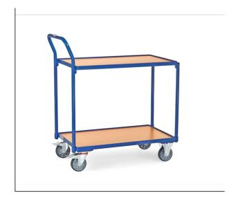
Ensemble mécano-soudé, revêtement époxy bleu RAL 5007 avec 2 plateaux en mélaminé surface effet hêtre, barre de poussée verticale, rebord de 12 mm. Charge maximum étagère haute : 80 kg. 2 roues pivotantes et 2 roues fixes à bandage TPE, moyeu à roulement à billes central. Freins sur roues pivotantes, conformément à la Norme EN 1757-3.
