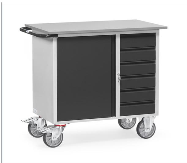
Construction en tôle d'acier, revêtement époxy, caisson gris RAL 7035, poignée de poussée et portes RAL 7016. 1 caisson placard avec 1 plateau de base fixe et 2 amovibles réglables. 6 tiroirs (H X L X P) 95 x 280 x 170 mm, verrouillage centralisé. Plan de travail en mélaminé renforcé, épaisseur 19 mm. 2 roues pivotantes et 2 roues fixes à bandage TPE, moyeu à roulement à billes central. Freins sur roues pivotantes conformément à la Norme 1757-3. Livré démonté, montage facile.
