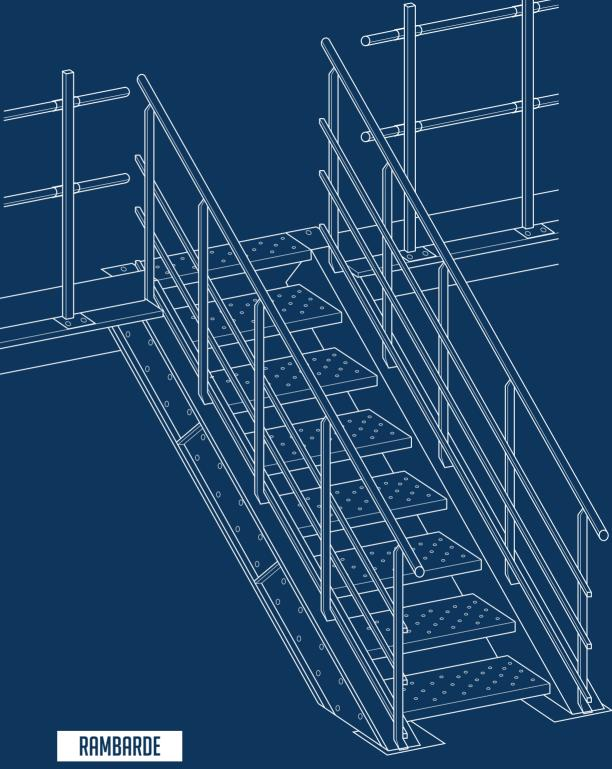
■ Poteau avec platine fixée sur le plancher
