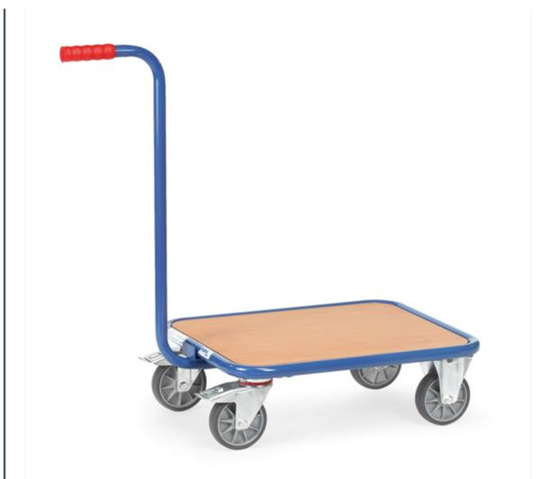
Chariot à col de cygne en tube d'acier, revêtement époxy bleu RAL 5007 avec plateau bois, poignée à boulonner, 2 roues pivotantes avec freins et 2 roues fixes à bandage TPE 125 x 32 mm, moyeu à roulement à billes central.
